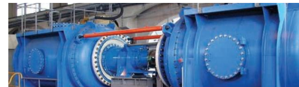
Le modèle intégral de la turbine bulbe (ALSTOM)
